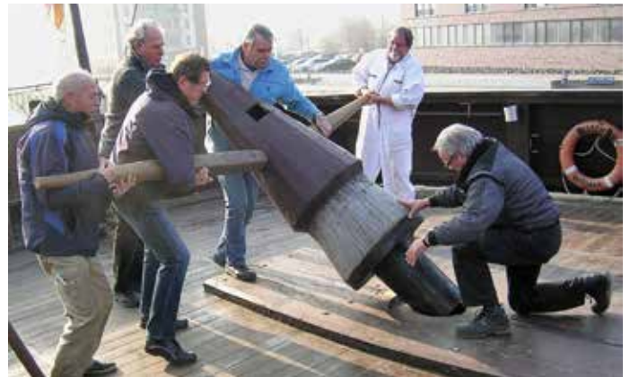
Einsetzen des Gangspills nach der Reparatur
