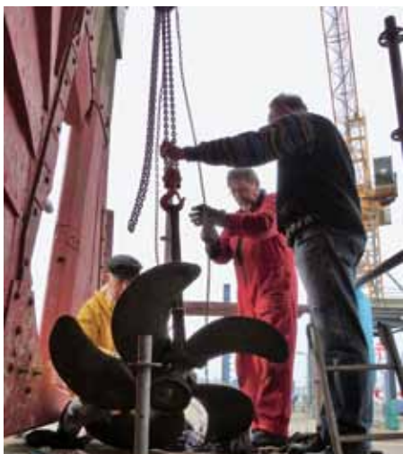
Nach zwei Jahren: Zustand des Bugstrahlruders und der Opferanoden
