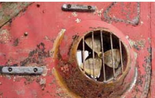
Nach zwei Jahren: Zustand des Bugstrahlruders und der Opferanoden
