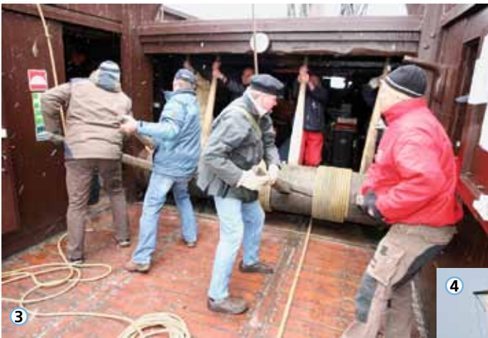
1: Das Bonnet wird angeschlagen (zweiter von links Sebastian Hentschel); 2: Das neue Segel in voller Pracht; 3: Die Rahe mit Segel wird mit dem Bratspill und der Muskelkraft der Crew hochgehievt; 4: Besucher lassen sich das Spektakel nicht entgehen; 5: Kapitän Pochert (links) und Joachim Müller begutachten die Qualität des Segels
