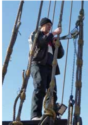
Links: Die Wanten werden mit einem Flaschenzug gespannt. Rechts: Die gewarteten Drehbassen kommen an Bord.
