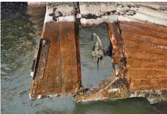
Zustand des Ruders und Propellers nach dem Eindocken
