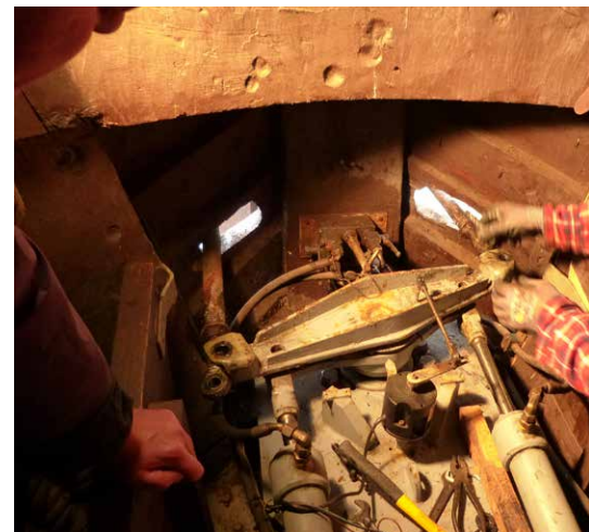
Arbeiten an der Ruderhydraulik
