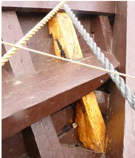
Ausgewechselter Spant im Bugbereich
