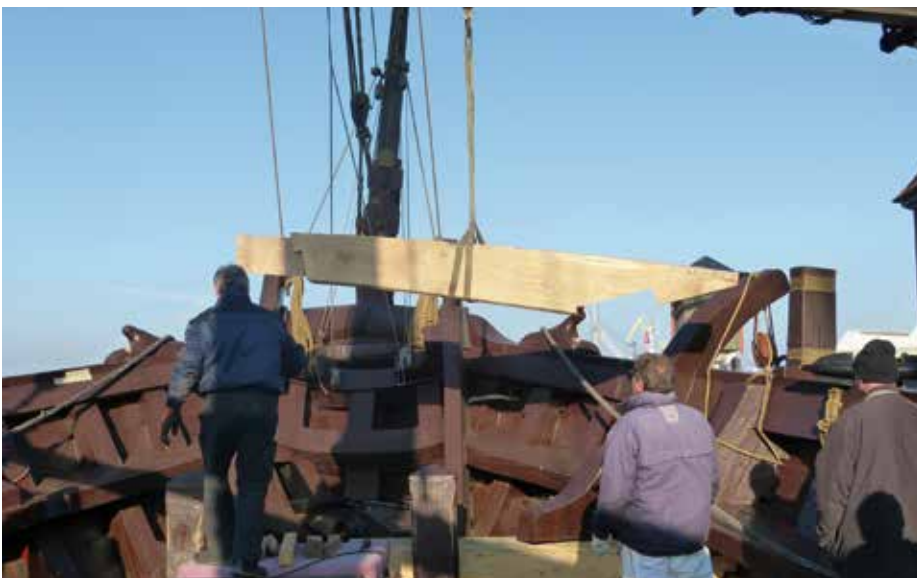
Die erste Hälfte „schwebt“ an Bord (l.) · alles eingepasst und verschraubt (r.o.) · Überlappung mittels schrägen Hakenblattes (r.u.)
