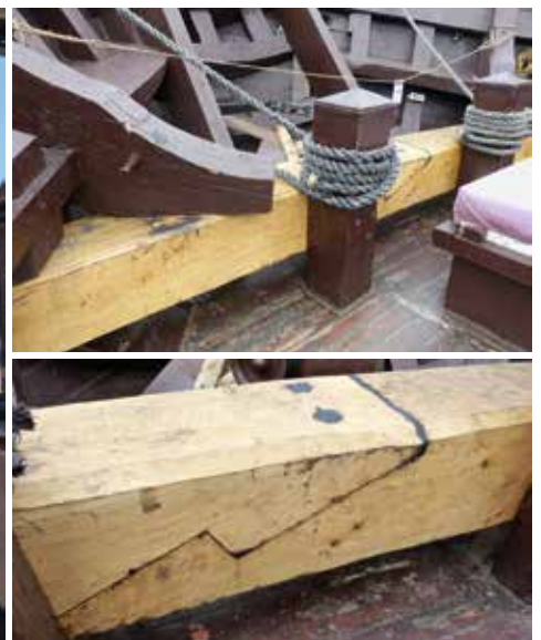
Die erste Hälfte „schwebt“ an Bord (l.) · alles eingepasst und verschraubt (r.o.) · Überlappung mittels schrägen Hakenblattes (r.u.)
