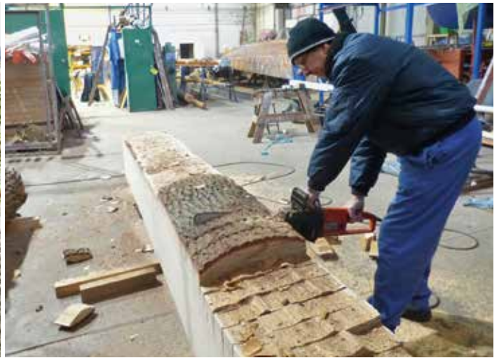
Im Sägewerk (l.): die Qual der Wahl des richtigen Eichenstammes · Rüdiger Haase beim ersten Schnitt (r.) vor dem Einsatz des Dechsels
